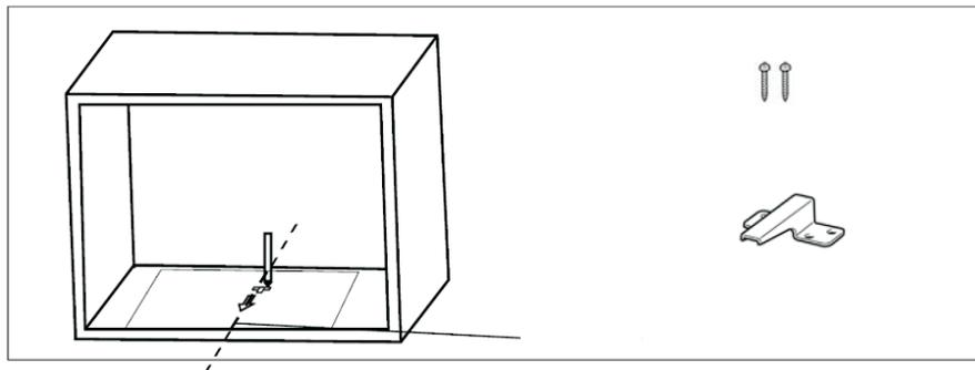
2. Parafuse os suportes A e B, com os parafusos C fornecidos, nos locais indicados.
