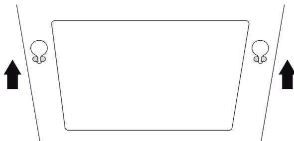
4. Encaixe a base do motor do exaustor na saída de ar de acordo com o tipo de instalação escolhida (vertical / horizontal).
