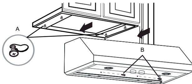
A. Parafusos de montagem 4 - 4x8mm
