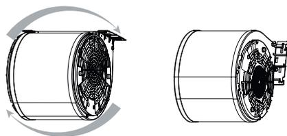
5. Insira as duas molas do motor do exaustor no compartimento de fixação e instale os 4 parafusos previamente liberados
