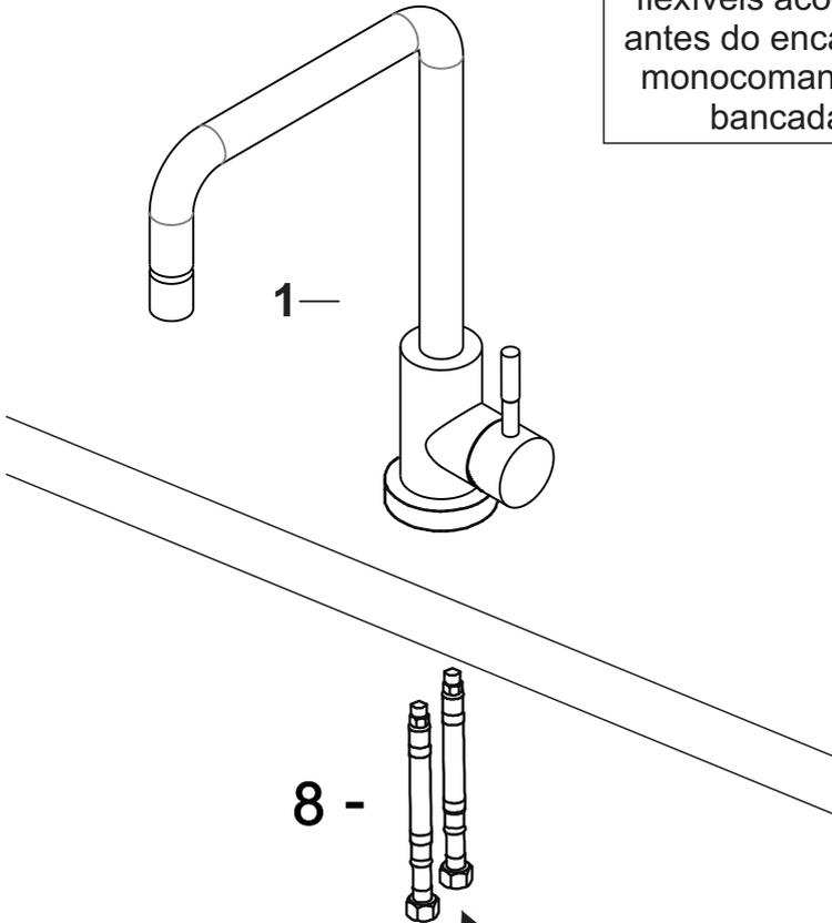
Finalize a conexão hidráulica considerando a ligação da água quente no flexível com detalhes em vermelho e a água fria no flexível com detalhes azuis.
